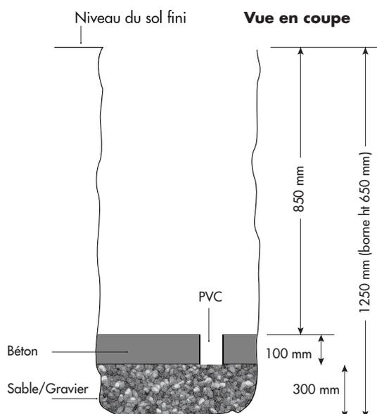
Vous adapterez la semelle en fonction de la nature du sol et des contraintes du site, afin de garantir le transfert de charge lors du roulement des véhicules sur la borne.
